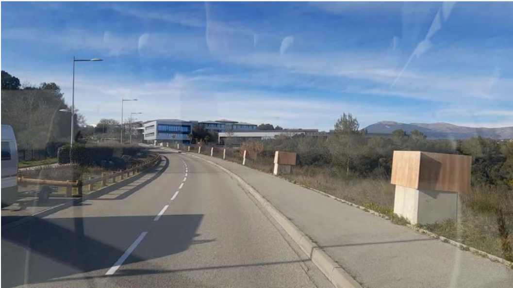
(a) Repères statiques du LiDAR.
