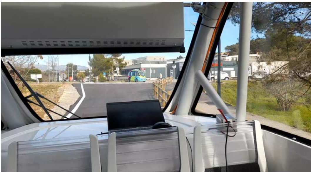
(a) Tests de croisement des navettes et interface avec les feux V2X
