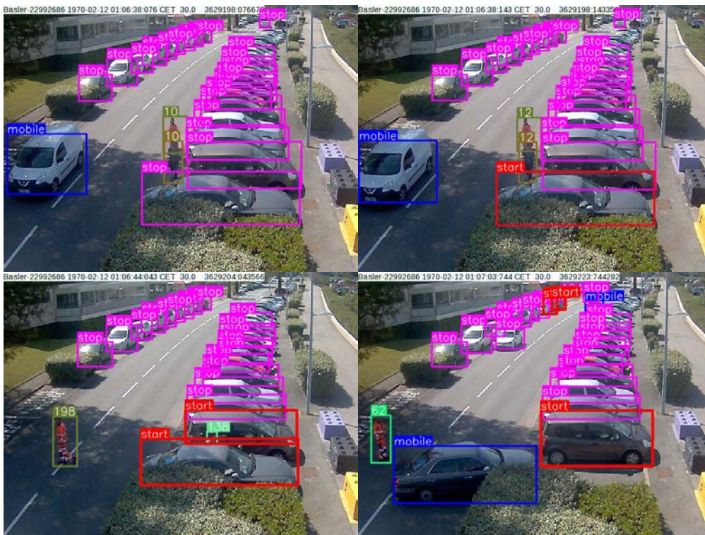
FIGURE 5 : DETECTION PRECOCE, 30S AVANT LA SORTIE, D'UNE SORTIE DE VOITURE A CHAMPS-SUR-MARNE, AVEC PARKINGS EN CRENEAUX EN BORDURE DE VOIES ET AVEC UN CAMERA ORIENTEE PERPENDICULAIREMENT A LA VOIE.
