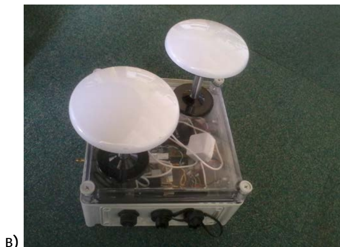
FIGURE 11 : A) BOITIER « EVABOX », B) PAIRE D'ANTENNES DE TYPE MARINE.
