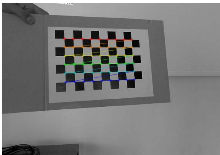
FIGURE 3 : LE RESULTAT NON DEFORME DE L'IMAGE DE L'ECHIQUIER UTILISE LORS DE L'ETALONNAGE INTRINSEQUE DE LA CAMERA AVEC OPENCV.
