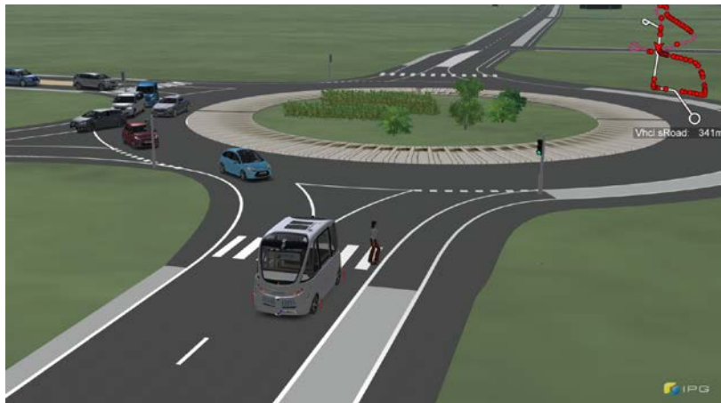
FIGURE 9 : EXEMPLE DE SIMULATION DU ROND-POINT DE DECINES-CHARPIEU SUR LE PARCOURS DU PARC-OL AVEC LE LOGICIEL IPG CARMAKER®
